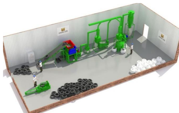
Рисунок 1. Макет цеха переработке автомобильных шин в крошку.
